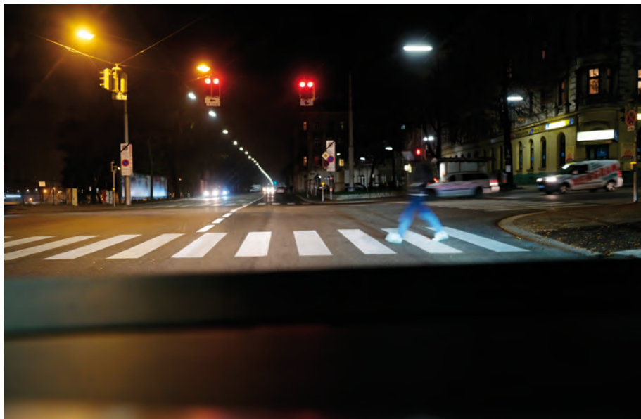
Abb. 5: Trotz angepasster heller Beleuchtung des Fußgängerüberganges ist hier gut erkennbar, wie die exakt geführten und hellen Autoscheinwerfer den Blick lenken und wie sehr der Oberkörper des Fußgängers im Gewirr der Lichter und in der Umgebungs Dunkelheit untergeht; Foto: © A. T. Neubau.
