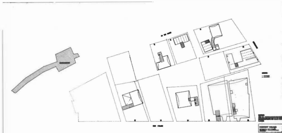
Abb. 3.1 Kellerkataster für das Quartier An der Mauer/Neue Straße. Architekt Horst Haag
