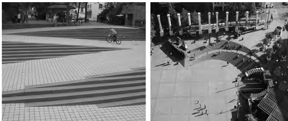
Abb. 4: Integration von Rampen in Treppenanlagen; links Trier (Foto: H. Topp); rechts Portland/Oregon (Foto: J. Gehl).
