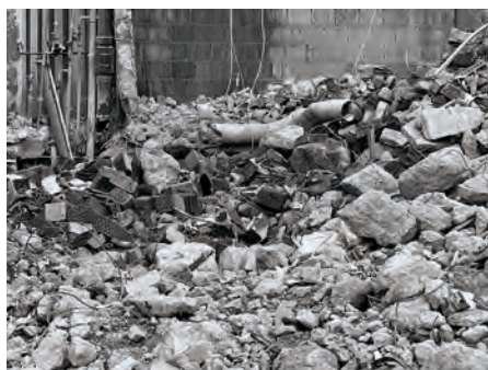
Abb. 1: Bauschutt besteht zum großen Teil aus mineralischen Materialien wie Ziegel und Beton; Foto: TU Darmstadt, FG est: N. Labidi.
