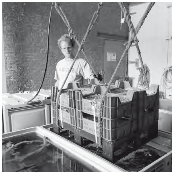
Abb. 7: Reinigung von Keramikfliesen aus den 1930er Jahren mit organischen Säuren in den Werkstätten von Rotor DC, Anderlecht (Brüssel), 2017; Quelle: Rotor DC .
